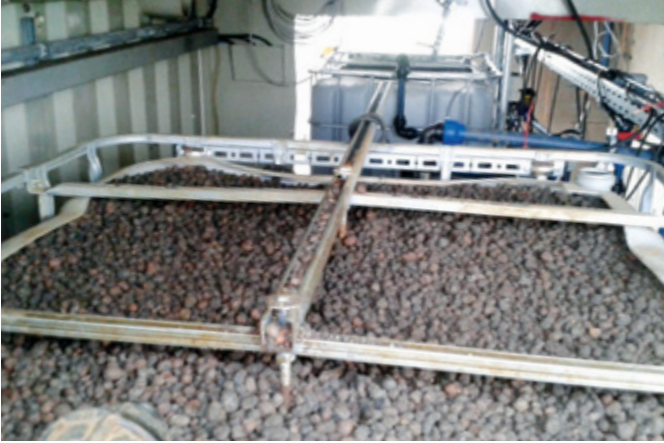
Pilotanlage mit Vertikalfiltern und Beschickern
