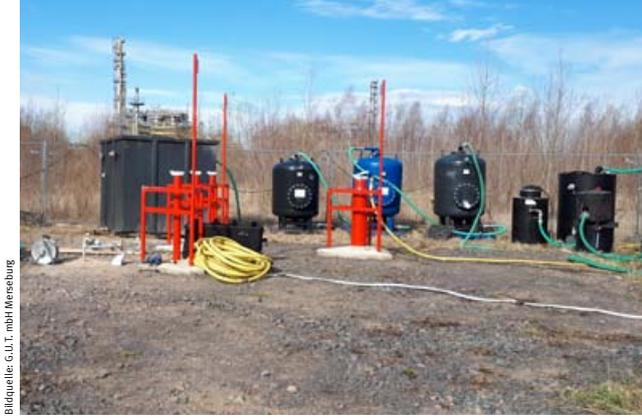
Sanierungsinfrastruktur für den Tensid-Versuch
