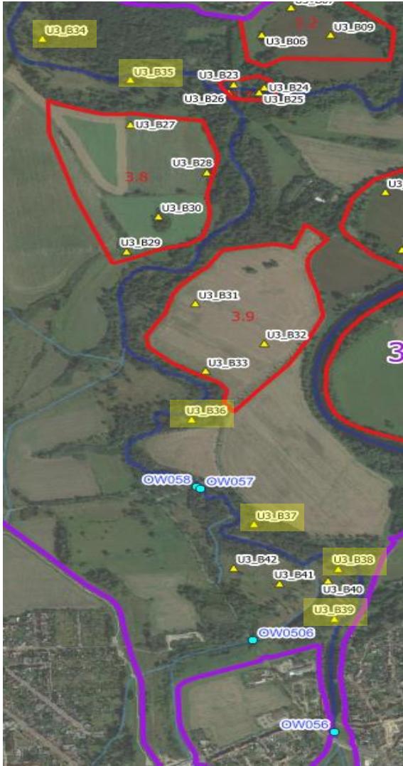
Abbildung 6.2: Probenahmestandorte U3_B34 bis U3_B39 (Summe HCH >100 mg/kg TS) für die Wiederholungsuntersuchung entlang des Spittelwassers (gelb markiert)
