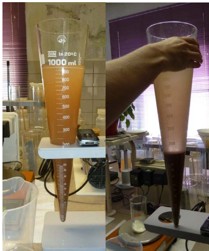
Foto 10: Sedimentprobe A, Absetzversuch; links: nach 30 Minuten in Leitungswasser; rechts: nach 20 Minuten in Salzwasser (40,2 mS/cm) (28.09.2011)
